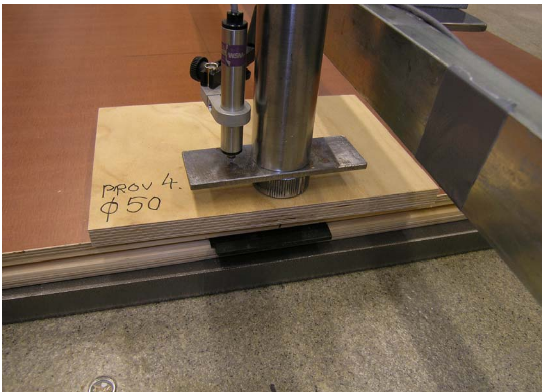
Bild 4. Belastningsläge vid kant med 50 mm provkropp och 18 mm plywood.
